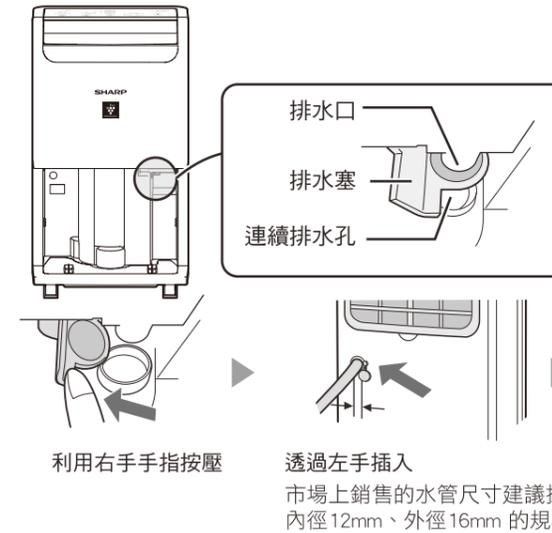
利用右手手指按住排水塞，並通過左手從主機背面的連續排水孔放入市面銷售的水管，再牢牢插入主機的排水口
