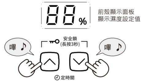
於濕度設定指示燈閃爍時，按上、下鍵設定目標濕度值，離手5秒後濕度設定生效。濕度設定指示燈恆亮。
