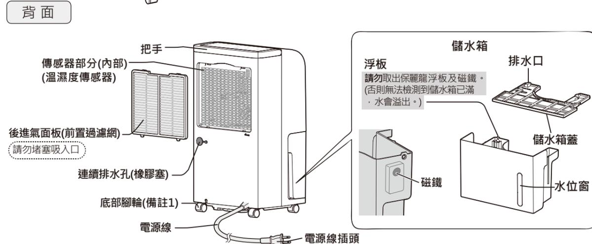
備註1: DW-P9HT-W為單向(左右)腳輪; DW-P11HT-W為萬向腳輪。
