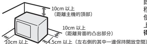
即使保持左圖所示尺寸的距離，烹飪過程中的油脂或蒸氣也可能混入排氣中，使排氣口附近的牆壁變髒。如果擔心牆上的汙垢，建議在牆面貼上鋁箔等。不得貼在產品上
