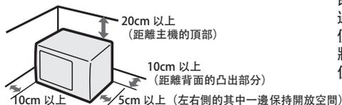
即使保持左圖所示尺寸的距離，烹飪過程中的油脂或蒸氣也可能混入排氣中，使排氣口附近的牆壁變髒。如果擔心牆上的污垢，建議在牆面貼上鋁箔等，但不得貼在產品上。
