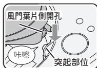
由正上方將另一側的風門葉片開孔，壓進本體側的突起部位內。
