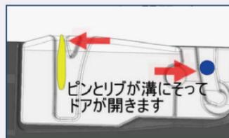
右邊門軸與固定滑片結構設計 沿著溝槽開啟 (示意圖)
