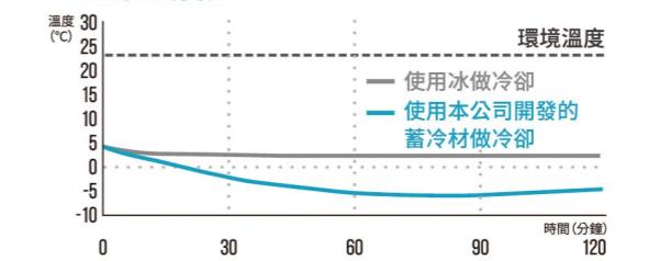
使用本公司的蓄冷材，先將飲品在冰箱中冷卻過，冰箱取出後搭配蓄冷材的飲品會再30分鐘後冷卻至零度以下，若是使用一般市面上融點0度的冰袋(一般家庭用的保冷劑)，無論經過多長時間，飲品溫度是無法降到0度以下。
