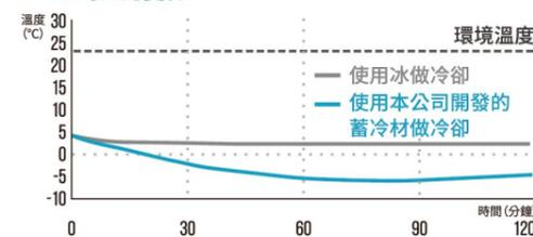
使用本公司的蓄冷材，先將飲品在冰箱中冷卻過，冰箱取出後搭配蓄冷材的飲品會再30分鐘後冷卻至零度以下，若是使用一般是市面上融點0度的冰袋（一般家庭用的保冷劑），無論經過多長時間，飲品溫度是無法降到0度以下。
